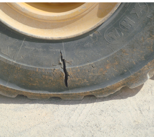
Pęknięcie boczne opony wielkogabarytowej
