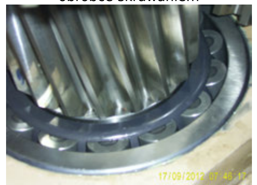
Łożysko posadowione z zregenerowanym gnieździe
