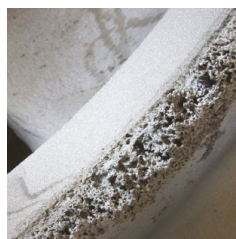
Fot. 5. Wżery kawitacyjne w warstwie wierzchniej korpusu pompy
