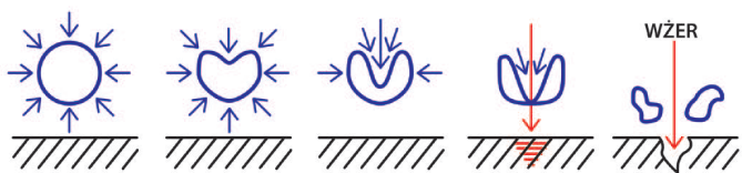
Rys.1. Przebieg zapadania się pęcherzyka z implozją w końcowej fazie procesu.
