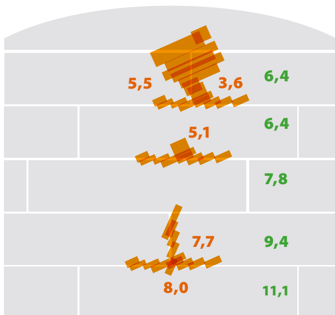
Rys.1. Pomiary ultradźwiękowe grubości płaszcza stalowego zbiornika cieczy procesowej. Na zielono grubości nominalne
