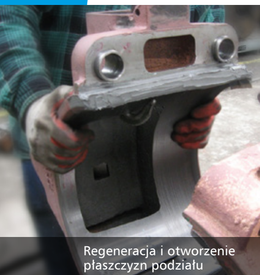
Technika spajania „na zimno” kompozytem Belzona
