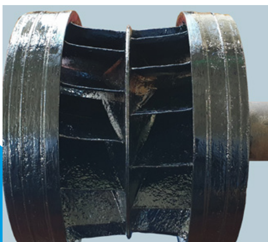
Zabezpieczenie łopat turbiny Francisa przed kawitacją
