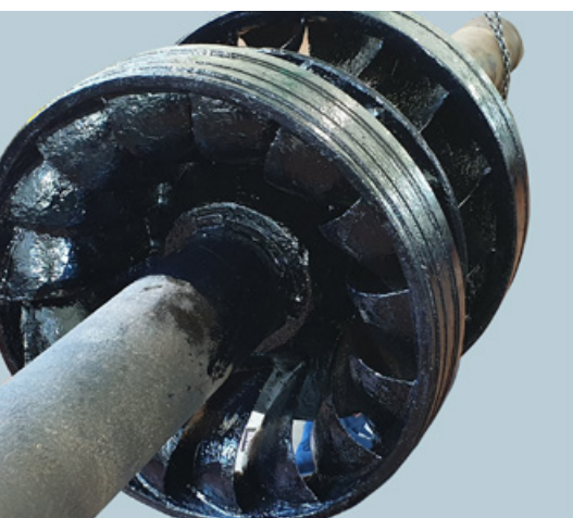
Zabezpieczenie łopat turbiny Francisa przed kawitacją
